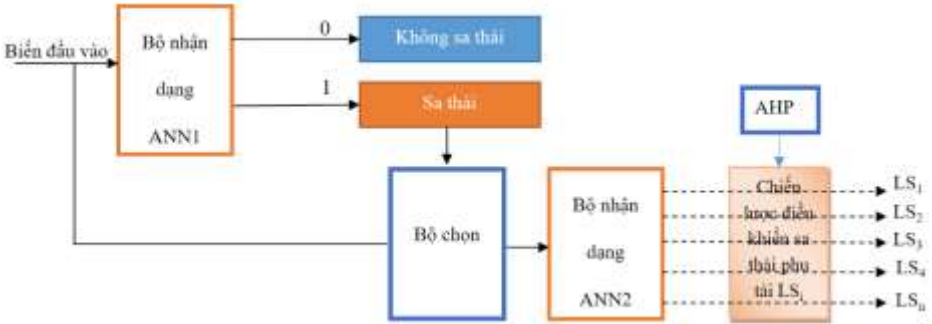
Hình 2.1: Mô hình nguyên lý điều khiển khẩn cấp sa thải phụ tải
